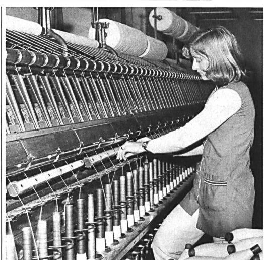
Ringspinnmaschine in der Streichgarnspinnerei.
