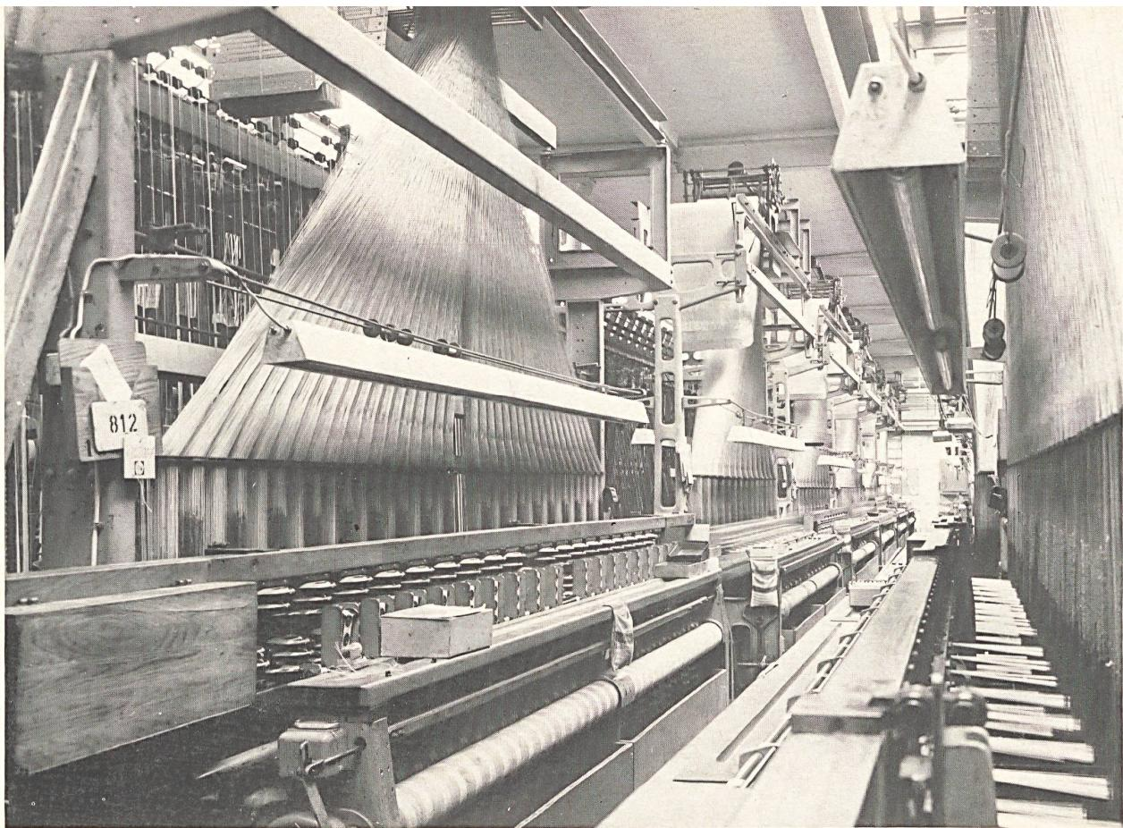
*Automates Jacquard pour le tissage de bandes d'étiquettes en plusieurs couleurs / Jacquard-Webautomaten für farbig gewobene Etikettenbänder / Jacquard automatic loom for weaving strips of labels in several colours.*
