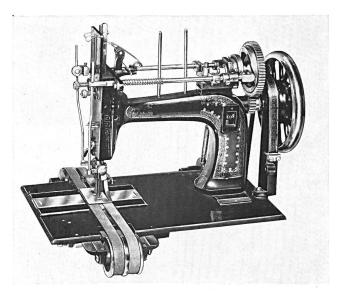
Elías Howe realizó en 1845 un progreso capital: el empleo de dos hilos para las costuras, un hilo inferior introducido por una lanzadera a través de las lazadas formadas por un hilo superior enhebrado en la aguja
