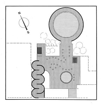
El plano de la sección « Vestidos y Atavíos » presenta ya distintamente las tres partes que componen esta sección. Abajo, a la izquierda, se reconoce los siete nichos semicirculares; arriba, a la derecha, el círculo grande de la cúpula entre las dos galerías con el taller de bordado y taller de relojería, así como el estanque circular.
