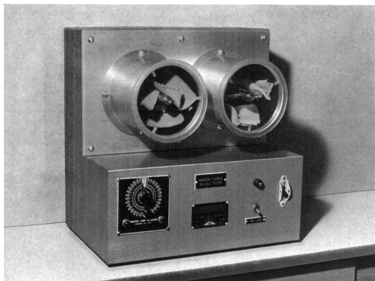
Aparato para comprobar la tendencia a la formación de motas de un tejido de hilos « Helanca »
