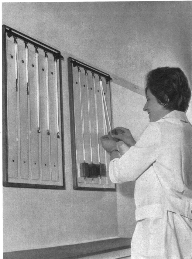
Control de la capacidad de extensión y de la contractilidad del hilado « Helanca » mediante pesos suspendidos
