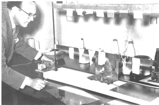
Demostrando la inflamabilidad de diversas muestras textiles.
