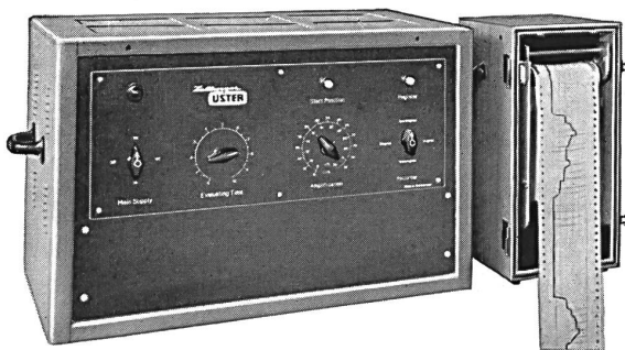
Espectrógrafo para analizar los resultados de medición de los hilados obtenidos con el regularímetro « Uster ».
