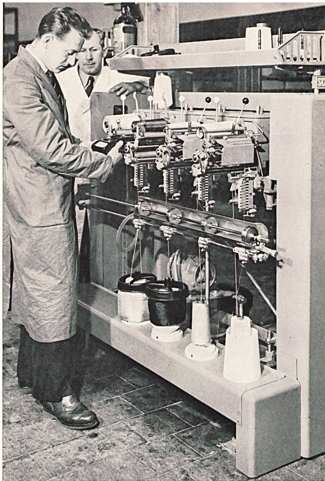
Verificación de una bobinadora.
