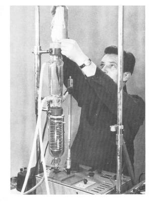
« Dyeometer », aparato para determinar la velocidad de absorción para el color de la tintura.
