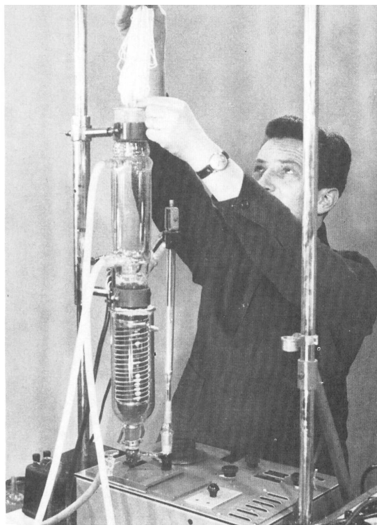
«Dyeometer», aparato para determinar la velocidad de absorción para el color de la tintura.
