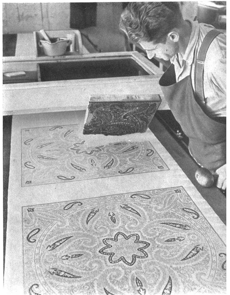
La estampación a mano. El obrero tiene en su mano izquierda el mazo, con cuyo mango golpeará sobre el bloque para aplicarle íntimamente sobre el tejido.
