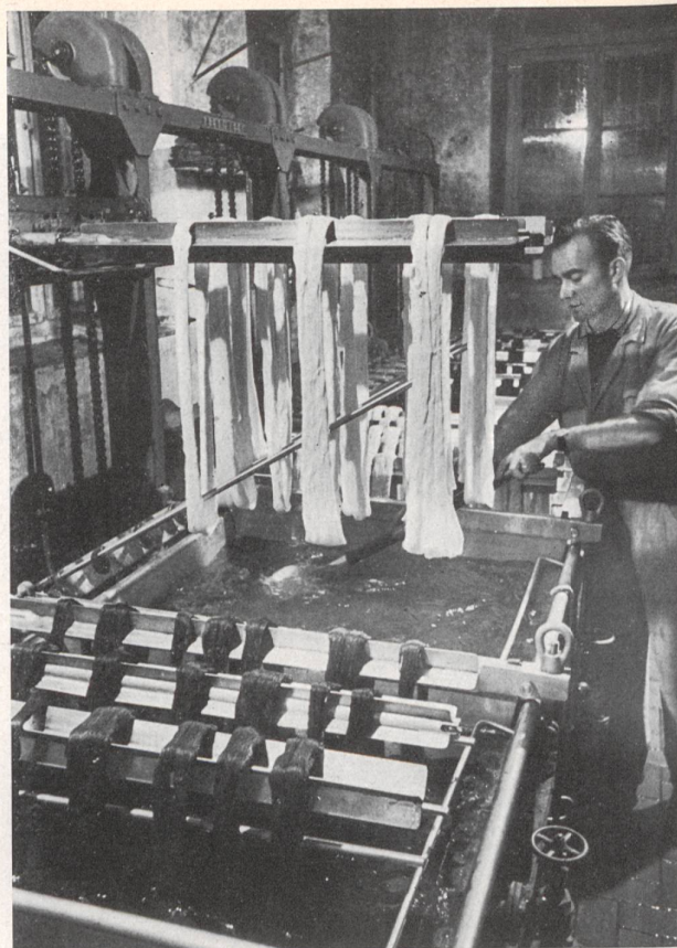
Máquina para teñir en madeja los torcidos de seda. Zwicky & Cia, Wallisellen.
