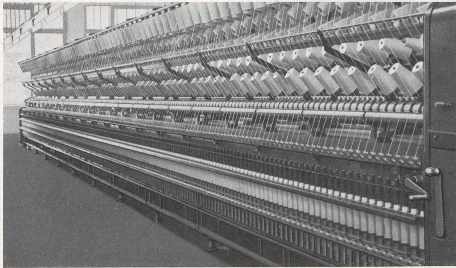
Vista general de una continua de torcer de anillos. Bäumlin, Ernst & Cia., St. Gallen.
