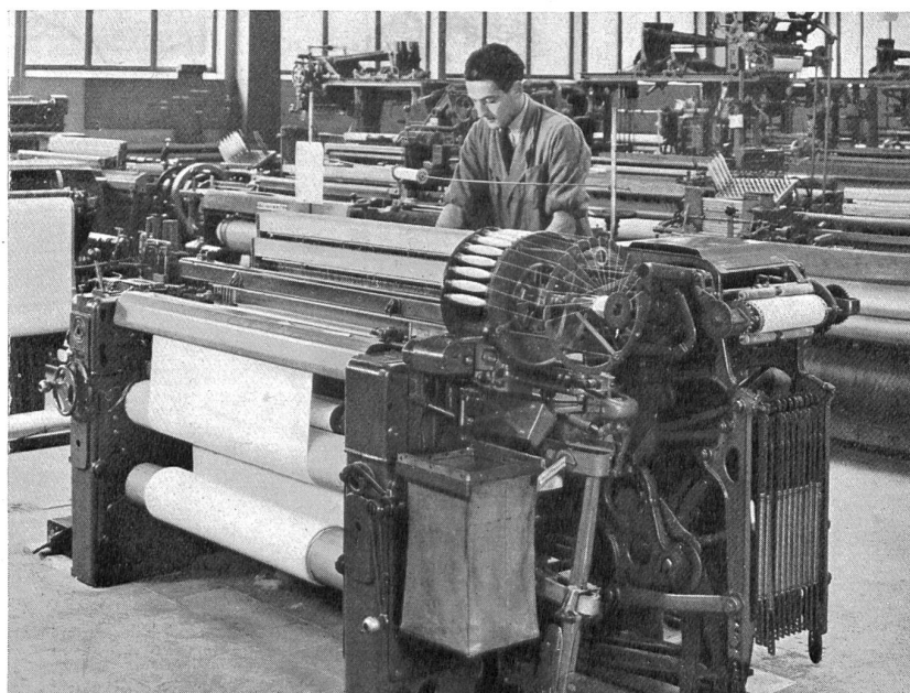
Un moderno telar con ratiere y con cambiador de canillas, en la escuela de Zurich.
