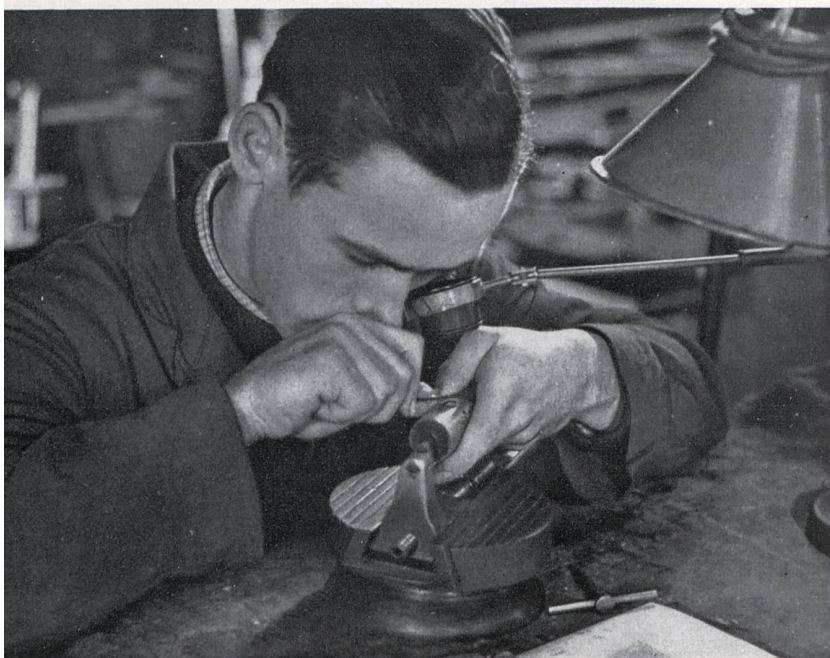
Grabado a mano y en relieve de una de las moletas de acero que servirá para reportar en hueco el dibujo grabado sobre un cilindro de cobre de los que se emplean para el estampado al rodillo.
