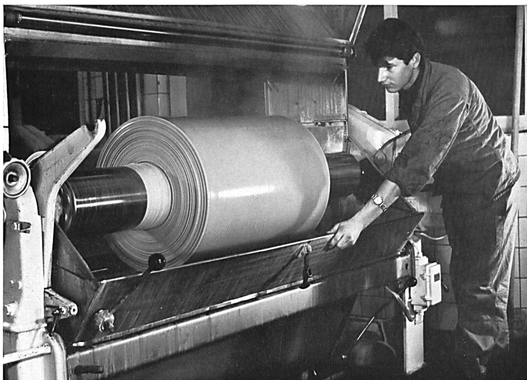
Teinture en pièce sur jigger automatique
