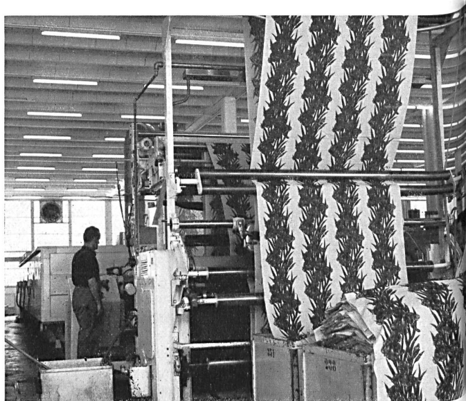
Départ du tissu dans la machine à apprêter
