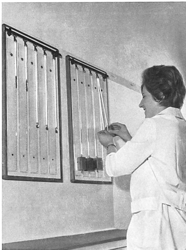
Contrôle de la capacité d'extension et de la contractilité du filé « Hélanca » au moyen de suspension de poids
