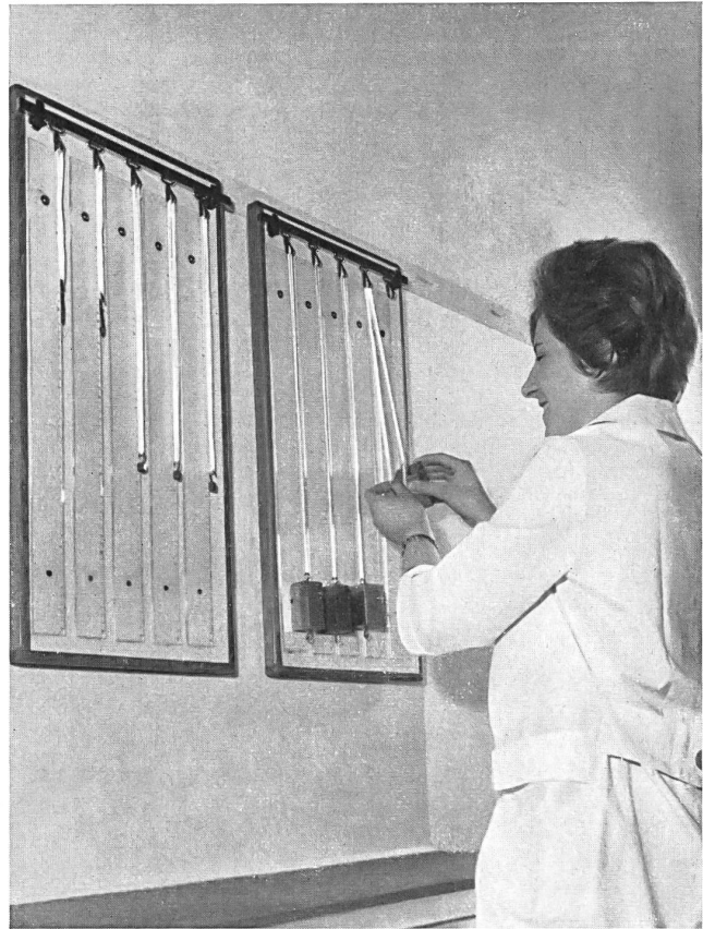
Contrôle de la capacité d'extension et de la contractilité du filé « Héralanca » au moyen de suspension de poids
