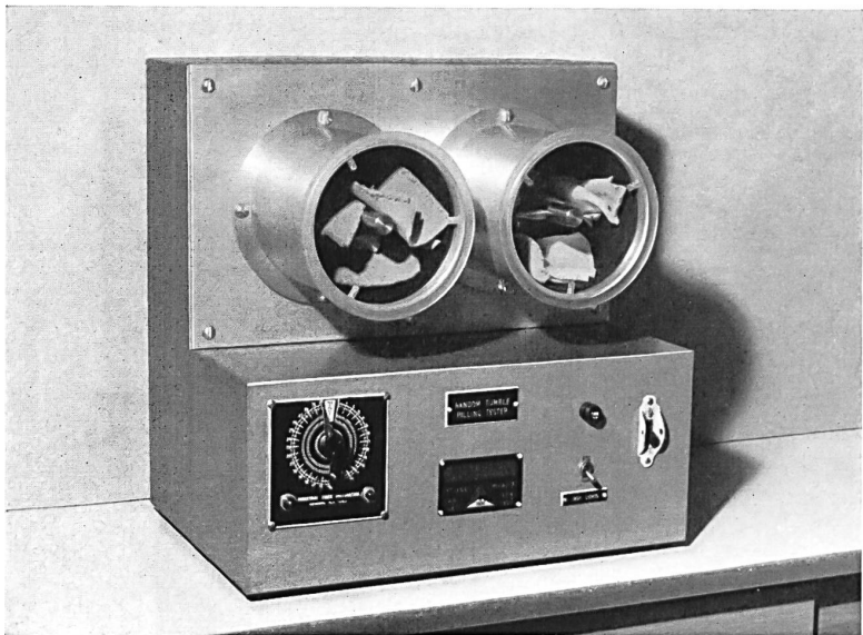
Appareil servant à contrôler la tendance au boulochage d'un tissu en filé « Hélanca »
