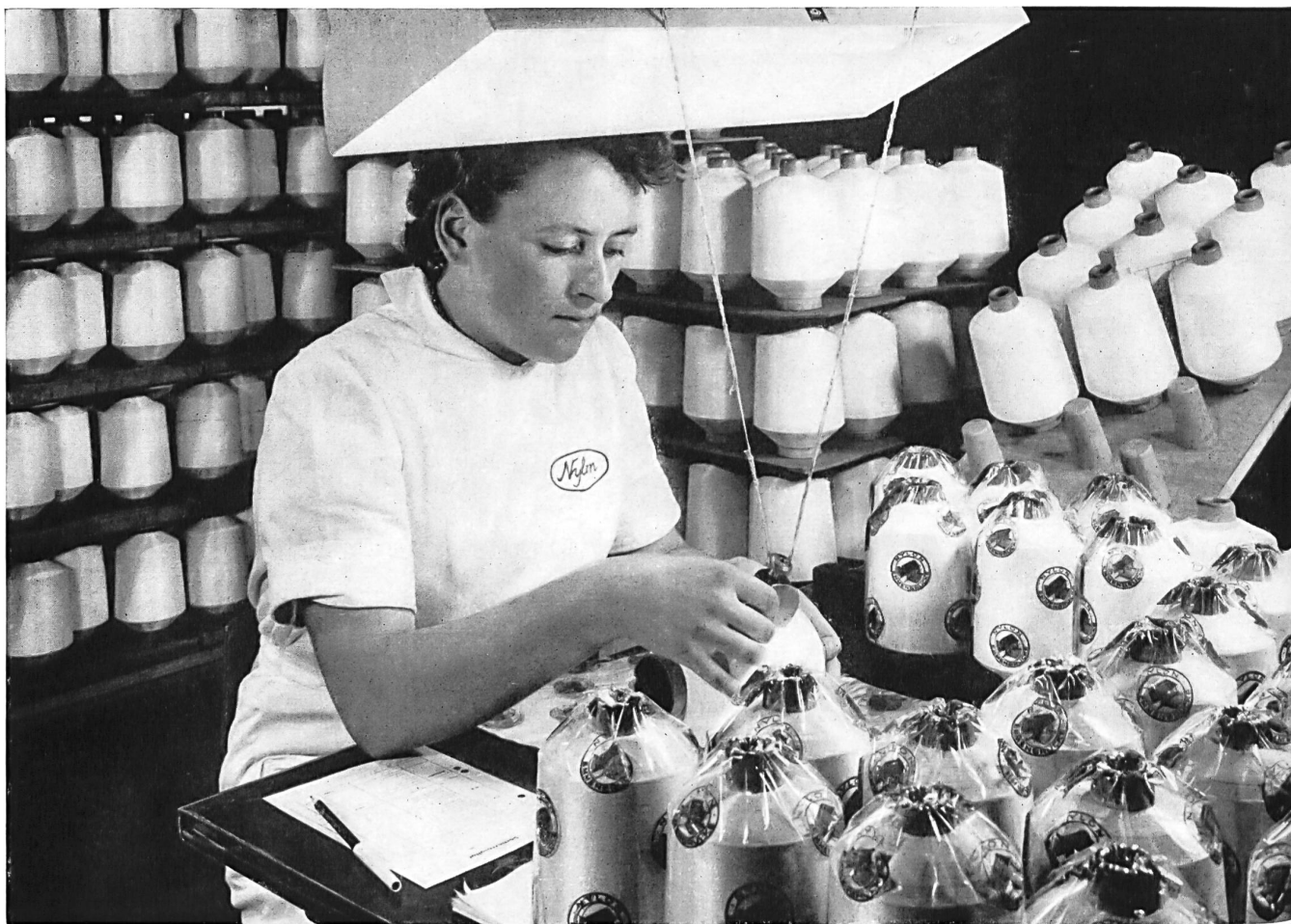
Contrôle et emballage des cônes de nylon « Nylsuisse » : examen de leur dureté et de leur propreté. Seuls les cônes répondant à des exigences sévères peuvent être utilisés pour la fabrication de textiles portant la marque « Nylsuisse »
