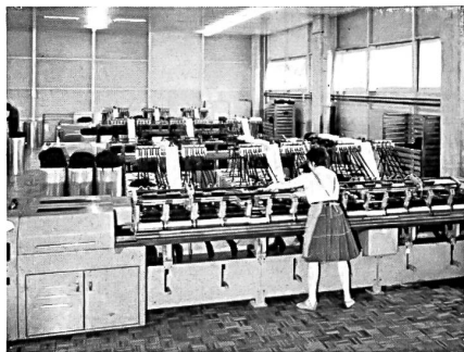
Machine ultra moderne pour l'étirage en fin dans une fabrique de laine peignée
