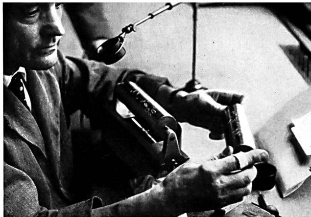
Gravure en vue de l'impression de tissus au rouleau (Cilander A.G., Herisau)
