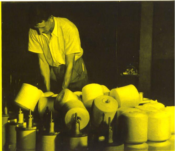
Grâce au «procédé Geigy de teinture Irgalane rapide» (Procédé TIR)\* il est possible de commencer les teintures en colorants Irgalane dans le bain préalablement chauffé entre 85 et 95° C. On obtient de la sorte, de façon fort simple, des teintures dont l'unisson et le tranchage sont excellents.
