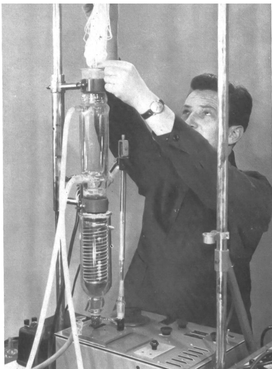
« Dyeometer » pour déterminer la vitesse d'absorption de la couleur dans les bains de teinture.
