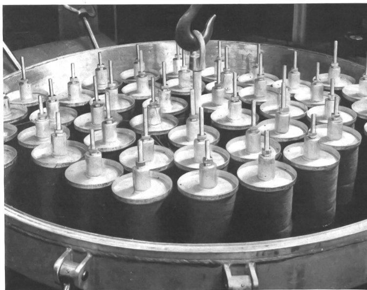
Appareil pour la teinture des bobines croisées.
