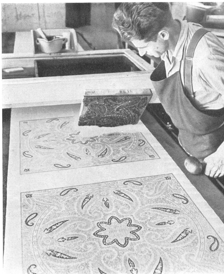
L'impression à la main. L'ouvrier tient dans la main gauche le marteau avec le manche duquel il frappera la planche pour l'appliquer étroitement sur le tissu.
