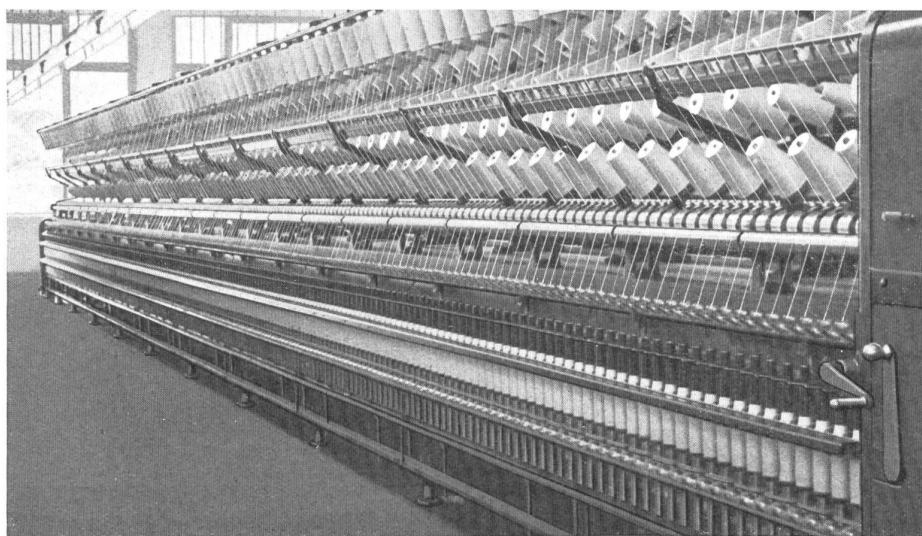
Vue générale d'une retordeuse à anneaux pour le coton.
