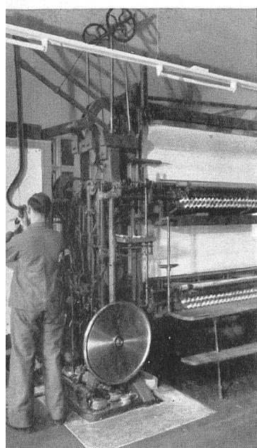
Brodeur actionnant le pantographe
