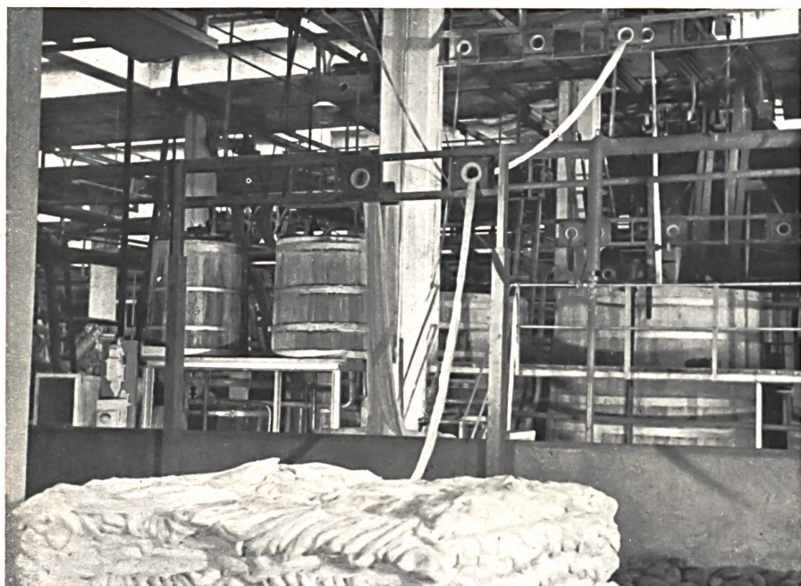
Blanchiment. Le tissu passe à travers des anneaux de porcelaine et descend dans la cuve où il sera soumis à l'action de divers bains.
