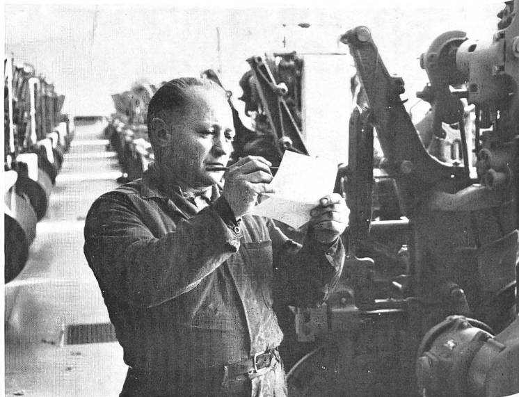
Aus Lochkarten ersehen die Spezialisten, welche Dispositionen zur Ausführung einer neuen Bestellung zu treffen sind. (Meyer-Mayor AG.)
