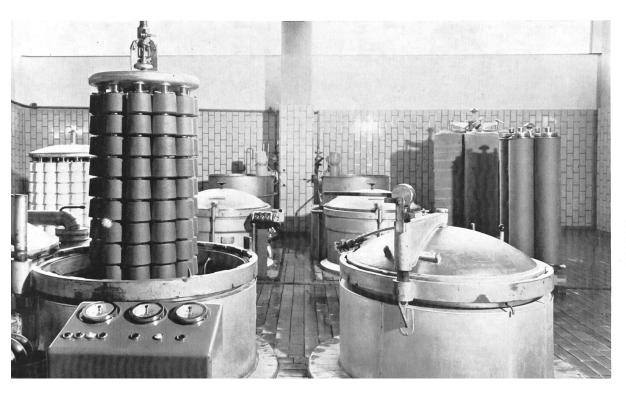
Die automatischen Färbeapparate « Duo-Mat » im Garnfärbe - Raum; hinten rechts, im Materialträger, die Färbebäume, auf welchen das Kardenband aufgewikkelt ist. (Stoffel AG.)
