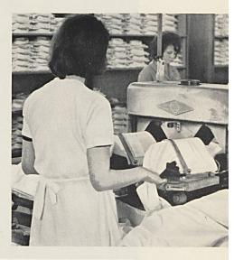
Eine Maschine legt den Hemdenstoff automatisch zum Zuschneiden bereit Rationalisierte Arbeitsgruppe in der Hemdenmacherei
