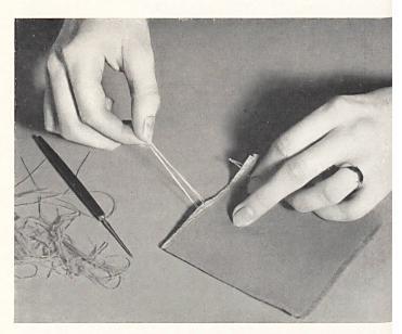
Fertigwarenkontrolle: Vorbereitung der Stoffprüflinge zum Pillingtest
