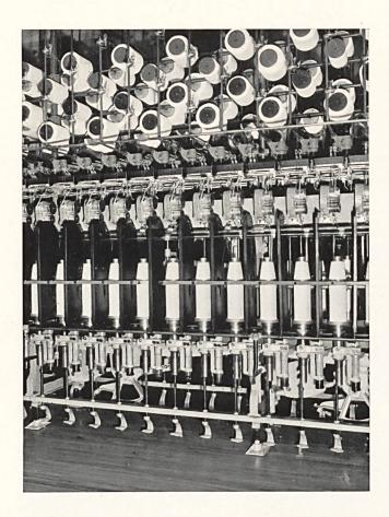
Hochleistungsringzwirnmaschine zum Zusammenzwirnen von je einem einfachen links- und rechts-gedrehten « Helanca »-Faden
