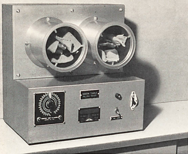
In diesem Apparat werden Gewebe mit « Helanca »-Garn auf ihre Neigung zum Büseln (pilling) hin geprüft:
