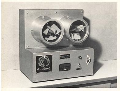
In diesem Apparat werden Gewebe mit « Helanca »-Garn auf ihre Neigung zum Büseln (pilling) hin geprüft:
