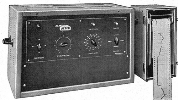
Der Spektrograph am «Uster» Gleichmässigkeitsprüfer ermöglicht eine rasche und genaue Analyse des Querschnittverlaufes von Garnen.
