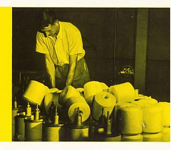
Das «Irgalan-Heiß-Färbeverfahren Geigy» (HF-Verfahren)\* ermöglicht es, Färbungen mit Irgalanen direkt in einem Färbebad von 85 bis 95°C zu beginnen. Mit dem HF-Verfahren werden auf einfachste Weise Färbungen von hervorragender Gleichmäßigkeit und Penetration erhalten.
