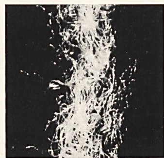
Derselbe Faserstoff, verarbeitet zu «Helanca»-Kräuseln (40 fache Vergrößerung).
