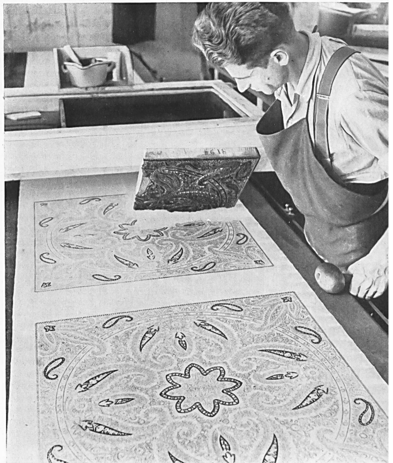
Handdruck. In seiner linken Hand hält der Arbeiter den Hammer, mit dem er auf das Grundbrett klopft, damit sich der Stoff eng daran anschmiegt.
