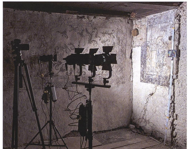
Abb. 1 Aufbau der Multispektralkamera.
