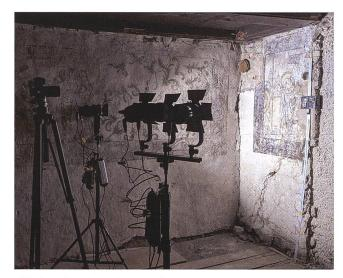
Abb. 1 Aufbau der Multispektralkamera.
