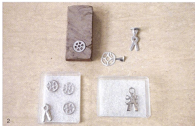
Abb. 5 Geschichte zum Anfassen und Selbermachen. 1 Gusstiegel mit flüssigem Zinn. 2 Sandsteingussform für Radanhänger; gegossene Rohlinge zum Überarbeiten und fertige Zinnanhänger.
