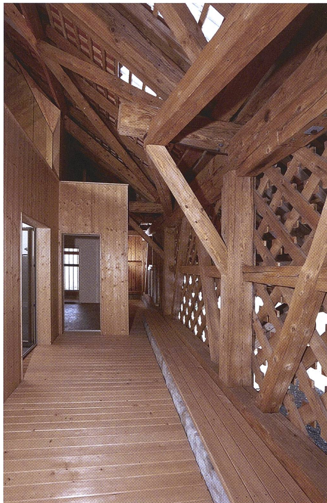
Abb. 31 Zug, Zugerberg, Juchenegg 2, Gadenhaus. Im Scheunenteil wurden die neuen Wohnräume als «Haus im Haus»-Konzept eingebaut. In den Zwischenbereichen zur Aussenhülle sind attraktive Loggien entstanden.
