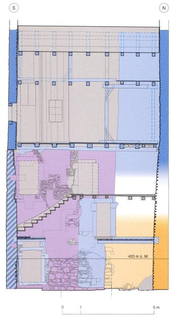
Abb. 4 Nord-Süd-Schnitt von Haus Unteraltstadt 22. Die Ansicht zeigt die Mauer, welche heute auf der einstigen östlichen Ehgrabengrenze verläuft. Blick Richtung Westen. Orange: Mauerwinkel des Vorgängerbaus an der einstigen «Untergass». Violett: Erste fassbare Überbauung des Ehgrabens (1511/12d). Blau schraffiert: Undatierte Mauer, jünger als violett und älter als blau. Blau: Bausubstanz des 16. Jahrhunderts (1521d). Grau: Moderne Bausubstanz bzw. nach 1521.
