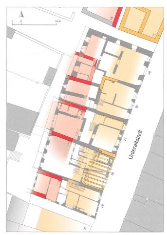
Abb. 9 Bauliche Befunde im Häusergeviert Unteraltstadt 20–28. Rot: Reste der östlichen Bebauung der einstigen «Untergass». Orange: Reste der westlichen Bebauung der einstigen «Mittelgass». Dazwischen verlief ein Ehgraben. Nördlich des Häusergevierts ist ein kleines Stück Ehgraben noch zwischen den Häusern Unteraltstadt 14 und 16 erhalten. Südlich des Häusergevierts wurde bei archäologischen Untersuchungen im Bereich der Häuser Unteraltstadt 30 und 32 vermutlich ebenfalls ein Ehgraben gefasst.
