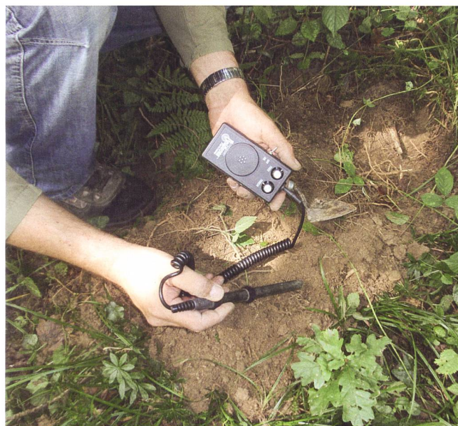
Abb. 5 Mithilfe eines handlichen Kleindetektors (Pinpointer) können Fundobjekte punktgenau geortet und dadurch gezielter geborgen werden. Im Bild der erste eingesetzte Pinpointer (Modell Uniprobe).
