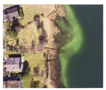
Abb. 33 Unterägeri, Ägerisee, Flachwasser vor Riederen. Fischfache im Flachwasser nördlich des Strandbades Unterägeri und südlich des Lorzenausflusses, die trichterförmigen Einzelelemente der Fischfanganlage sind im senkrechten Nahbereichsluftbild gut zu erkennen.
