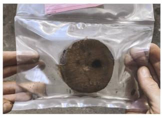
Abb. 1 In Plastikfolie eingeschweisste Holzprobe, bereit zur Einlagerung im Zweiten-Weltkrieg-Bunker.
