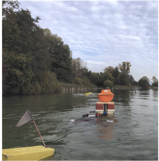
Abb. 29 Risch, Zweieren. Die Tauchequipe bei der Arbeit. An den gelben Styroporklötzen (Vordergrund und Hintergrund) sind die Pressluftflaschen befestigt, in der leuchtend orangefarbenen Boje befindet sich die «Hydra», ein DGPS-Gerät zur Einmessung der Pfähle.
