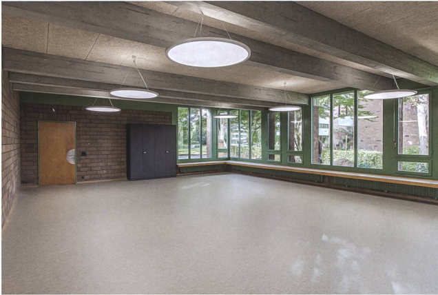
Abb. 3 Im zurechtgemachten Klassenzimmer orientiert sich die Gestaltung mit Ausnahme der Beleuchtung am historischen Vorbild. Die elektrischen Anschlüsse sind unsichtbar unter der Fensterbank integriert.
