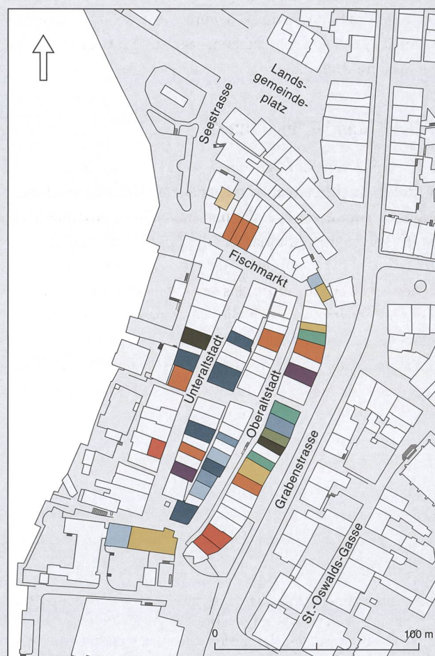
Altstadt von Zug. Die Farben kennzeichnen das ermittelte Fälljahr der in der ältesten dendrochronologisch fassbaren Bauphase verbauten Hölzer. Dendrochronologisch nicht datierbare Bauteile (Mauern), die gemäss den Erkenntnissen der Bauvorsuchung jedoch aus der Zeit vor dem Stadtbrand im 14. Jahrhundert stammen, sind auf dieser Darstellung nicht vermerkt. Bei den markierten Gebäuden bzw. Gebäudeteilen kann es sich um komplette Neubauten handeln oder auch um solche, bei denen Instandstellungsarbeiten oder Erweiterungen nachgewiesen werden konnten.
