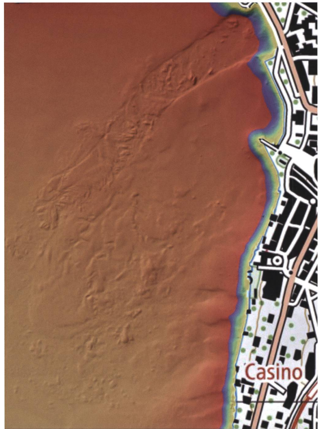
Abb. 15 Seit 2016 ermöglichen hochaufgelöste Vermessungsdaten zur Seebodentopografie (Bathymetrie) einen faszinierenden Blick in unsere Seen. In der Reliefschattierung zeichnet sich der grosse Seeuferabbruch von 1887 in der Zuger Vorstadt, im Bereich der heutigen «Katastrophenbucht», als lang gestreckte Schuttzunge ab. Ein grosser archäologischer Bestand hat sich unter Wasser abgelagert. Auch entlang der Zuger Altstadt sind die Rutschmassen verschiedener, nicht datierbarer Abbrüche sichtbar, darunter vielleicht auch derjenige der 1435 abgerutschten «Nideren Gass».
