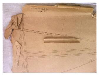
Abb. 6 Beschädigter Plan mit Stauchungen, Rissen und Fehlstellen. Aus der Restaurierungsdokumentation von Gertrud Künzli, 2016.
