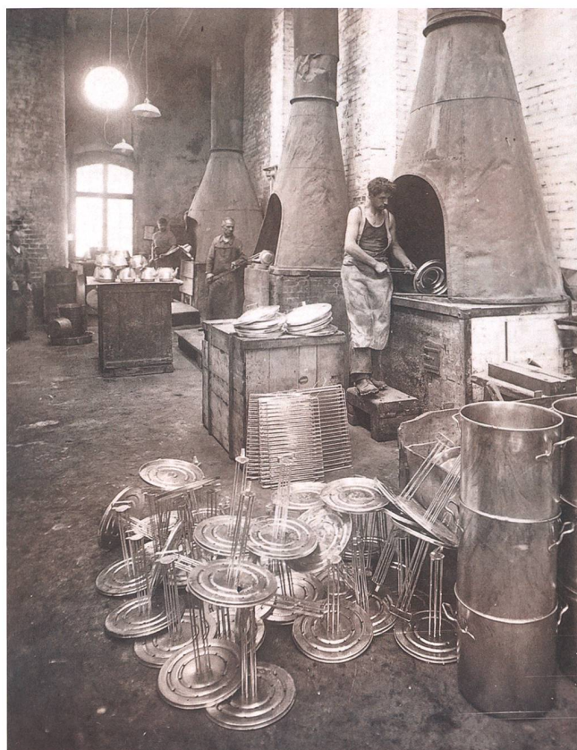
Abb. 6 Verzinnungsöfen, 1930er Jahre. Fabrikabteilungen mit Öfen waren besonders stark vom Kohlenmangel während der Kriegszeit betroffen.
