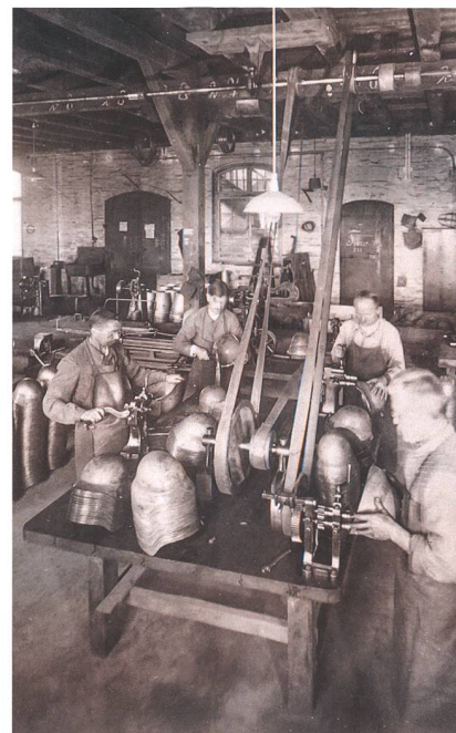
Abb. 8 Helmfabrikation in der Metallwarenfabrik Zug, 1930er Jahre. Anfang 1918 begann die Metallwarenfabrik mit der Serienproduktion des neuen Stahlhelms Ordonnanz 1918 der Schweizer Armee.
