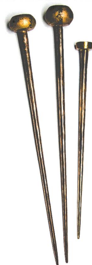
Abb. 3 Die roh gegossenen Nadeln nach dem Entfernen der Eingüsse. Der Schaft ist schon ausgeschmiedet.
