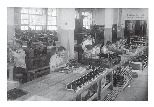
Abb. 5 Montage und Prüfung von Gleichstromzählern bei Landis & Gyr in Zug, ca. 1920.
