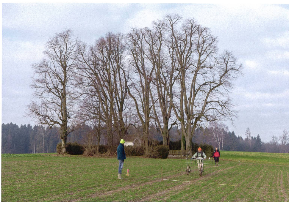
Abb. 3 Cham-Lindencham, Heiligkreuz. Geomagnetische Prospektion auf dem mit Wintergetreide bestandenem Acker vor der Lindencapelle. Das Magnetometer wird von Christoph Rinne in einem Rasenmähermuster über die Untersuchungsfläche geschoben. Zwei Helfer, Clemens Schmid und Michael Jürgensen, stecken nach jeder Bahn die der Orientierung dienende Leit-schnur in definierten Abständen entlang eines Massbands um.
