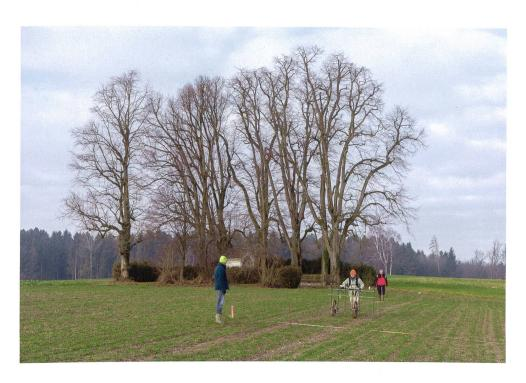
Abb. 3 Cham-Lindencham, Heiligkreuz. Geomagnetische Prospektion auf dem mit Wintergetreide bestandenen Acker vor der Lindenkapelle. Das Magnetometer wird von Christoph Rinne in einem Rasenmähermuster über die Untersuchungsfläche geschoben. Zwei Helfer, Clemens Schmid und Michael Jürgensen, stecken nach jeder Bahn die der Orientierung dienende Leitschnur in definierten Abständen entlang eines Massbands um.
