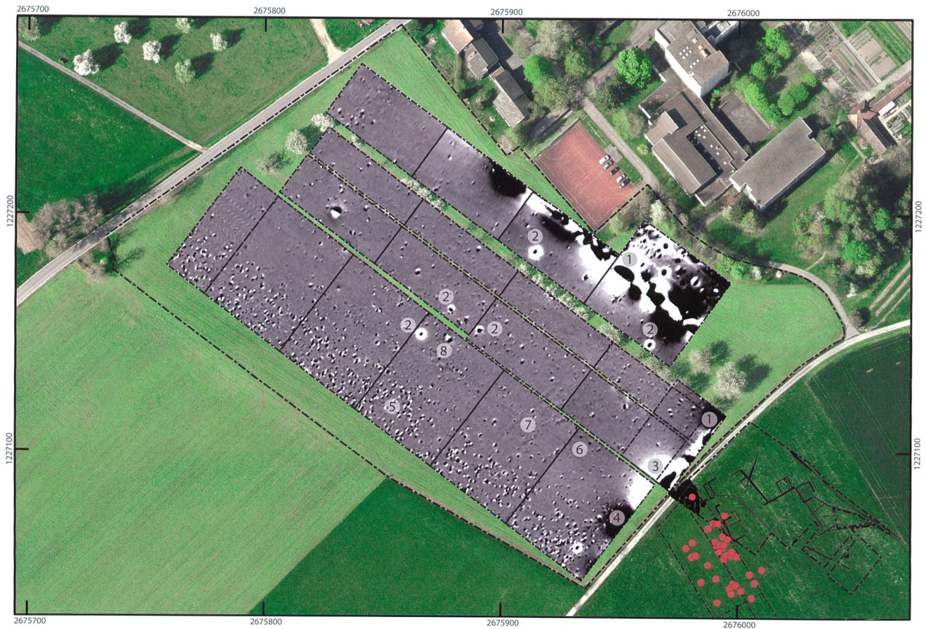
Abb. 4 Cham-Lindencham, Heiligkreuz. Ergebnisse der Geomagnetik als Graustufenbild ( -7 bis +7 nT). Positive nT-Werte werden dunkel, negative hell dargestellt. Rechts unten befinden sich die Befunde der Grabung 1933–1935 (nach Hofmann 1993, Abb. 2). Die roten Punkte markieren die Fundpunkte der Metalldetektorprospektion im Frühjahr 2017. Kartenhintergrund: kantonaes Luftbild 2016, Koordinatenangaben in LV95.
