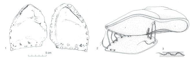
Abb. 15 Zug, Unteraltstadt 26. Flicksohle mit Tunnelstichen eines rechten Schuhs in Erwachsenengrösse (FK 186-38.24). 1 Ansicht der Narbenseite (links) und der Fleischseite (rechts) mit Fussabdruck. 2 Rekonstruktion eines wendegenähten Schuhs mit Nachbesohlung. 3 Schematische Profilzeichnung mit sogenanntem Tunnelstich.
