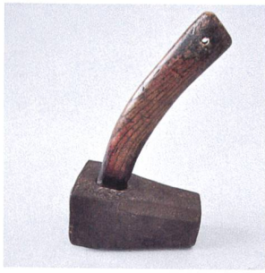
Abb. 4 Hammer eines Feilenhauers mit dem typisch gebogenen Stiel, 1960–1970.
