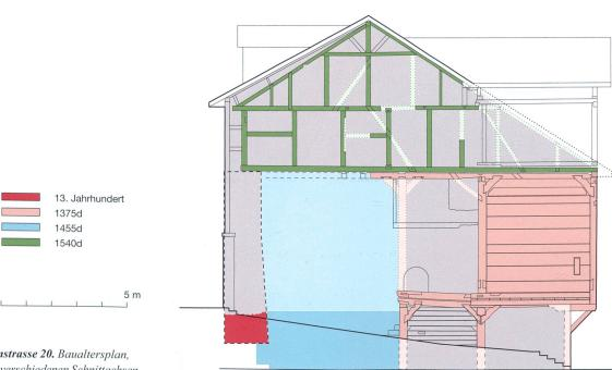
Abb. 34 Zug, Grabenstrasse 20. Baualtersplan, zusammengesetzt aus verschiedenen Schnittachsen.
