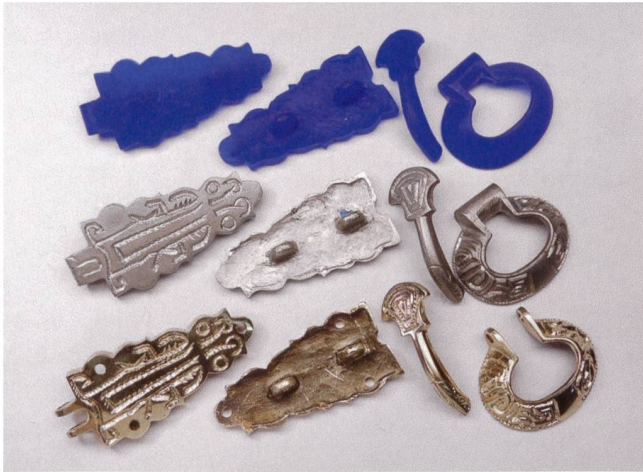
Abb. 5 Für die originalgetreue Nachbildung einer frühmittelalterlichen Gürtelgarnitur wurden zuerst ein blaues Feilwachsmodell (oben), dann ein Modell aus einer Blei-Zinn-Antimon-Legierung (Mitte) und schliesslich die Replik aus Bronze (unten) hergestellt.
